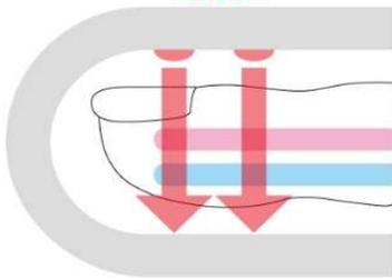
指を機器の中に入れて LEDの光を血管に当て、その透過光を測定します。
